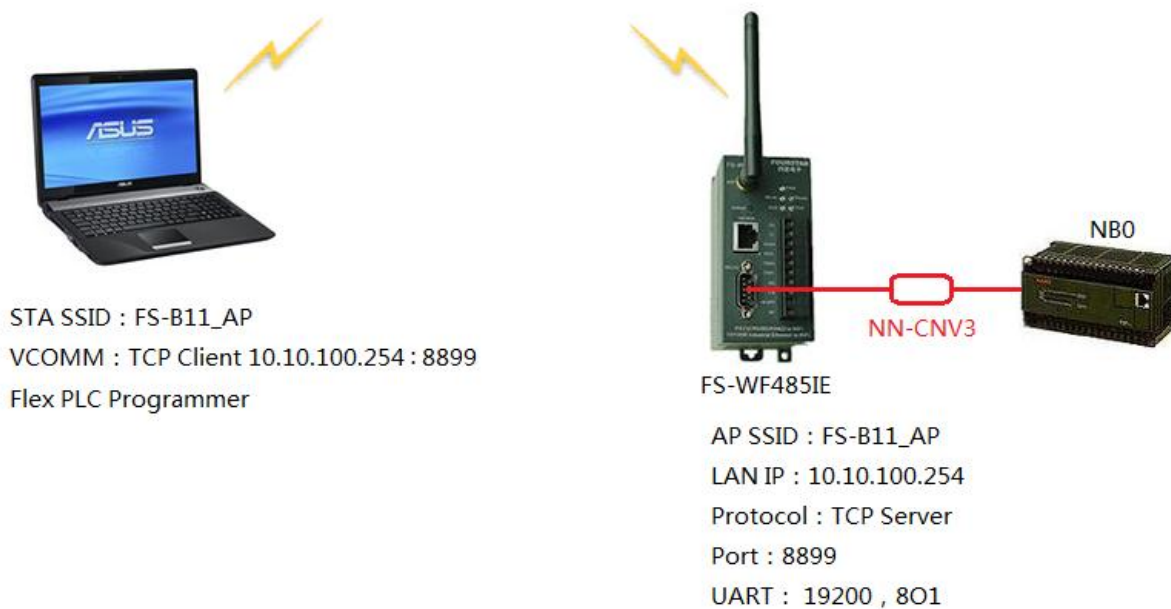
图 10-1 电脑与富士 NB0 PLC 无线通信
