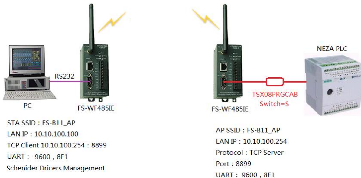
图 5-2 MODBUS RTU 通信测试
