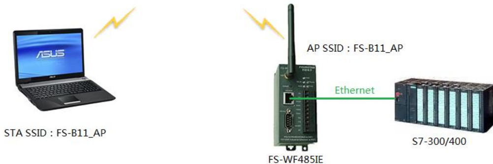
图 3-2 用 FS-WF485IE 实现电脑与 S7-300/400PLC 的以太网口无线通信
