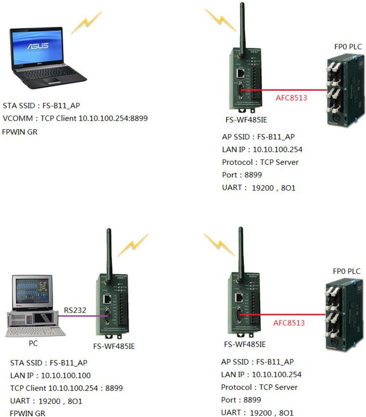
图 7-1 电脑与松下 FP0 PLC 的无线通信
